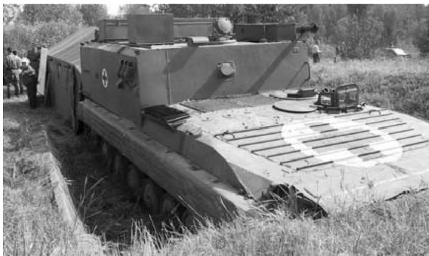
Бронированная медицинская машина (БММ-1) на базе боевой машины пехоты БМП-1
