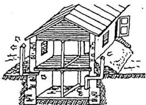
Противорадиационное укрытие в подвале дома
