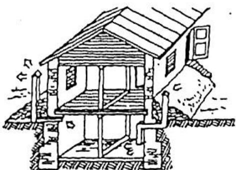
Противорадиационное укрытие в подвале дома
